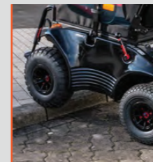
Suspensão e alta capacidade de subida, excelente para terreno extremamente irregular.
