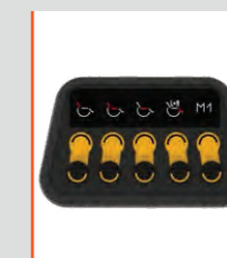
Teclado de controle de funções elétricas até 5 ajustes de assento, também durante a condução separado para seleção direta.
