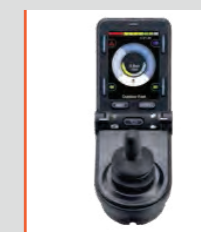
Módulo de controlo com LCD de 3,5" para uma ampla visualização e operação das funções da cadeira. Bluetooth e Infravermelhos incorporados para um controlo facilitado através do smartphone.
