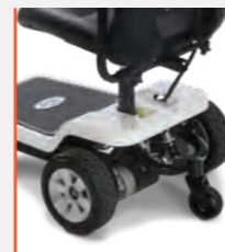
Motores de 200 W de potência e peso máximo de utilizador de até 20 kg.
